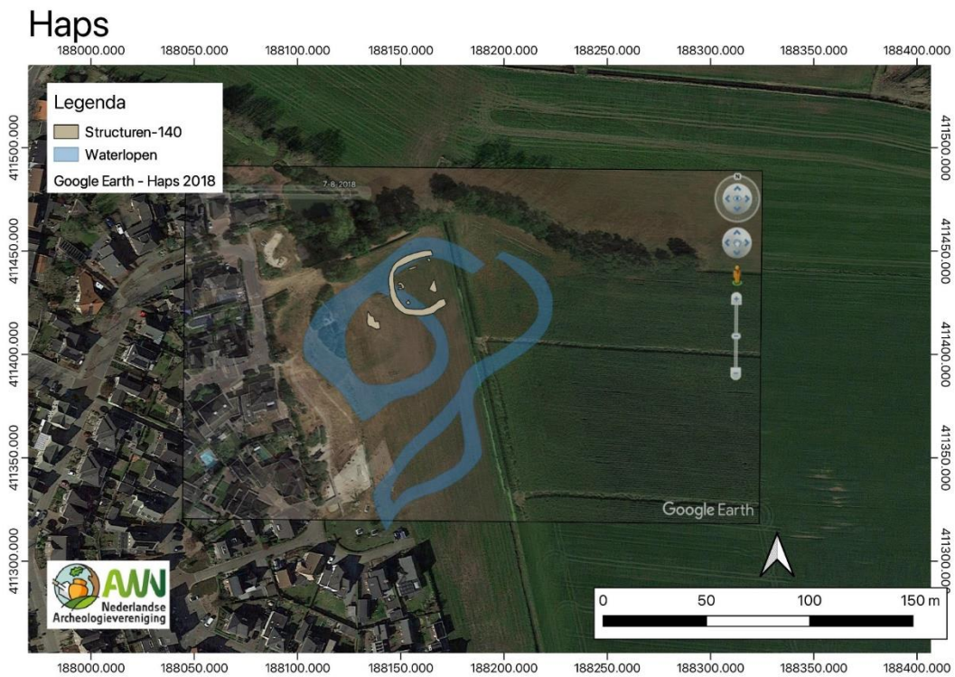
Afbeelding 38 Luchtfoto Google Earth 2018 met de projectie van de waterlopen en de reflecties van de radarmeting op een diepte van 140 cm (Ruud Raats).
