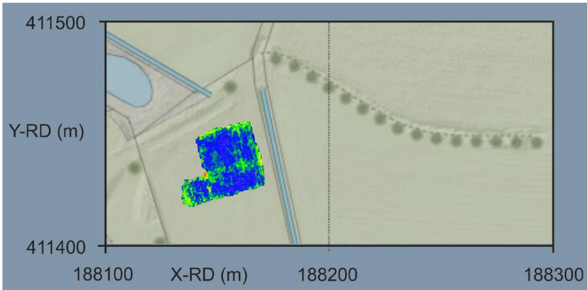
Afbeelding 22 Doorsnede Radarscan op een diepte van 60 cm, geprojecteerd op kadasterkaart 2021.
